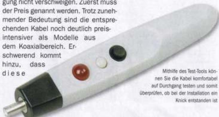
Mithilfe des Test-Tools können Sie die Kabel komfortabel auf Durchgang testen und somit überprüfen, ob bei der Installation ein Knick entstanden ist
